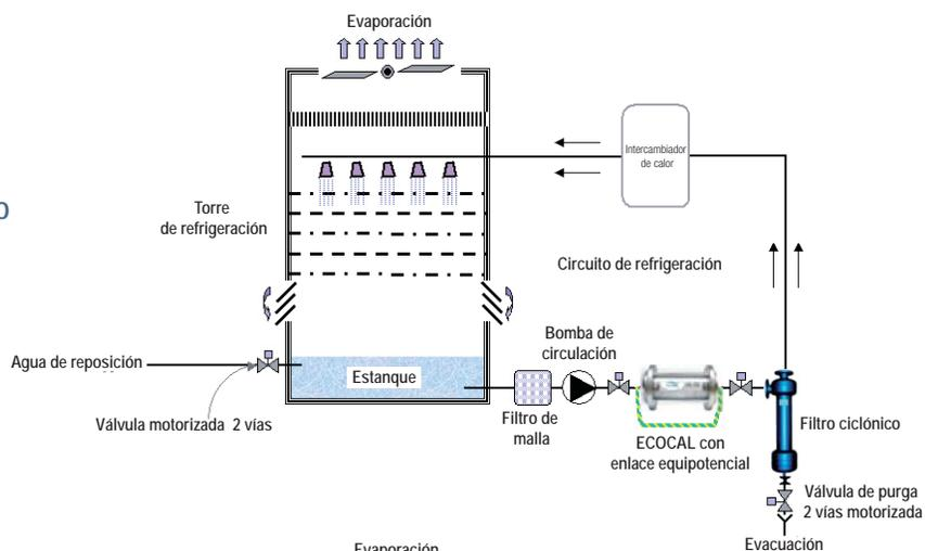
Montaje en derivación sobre circuito de refrigeración.
