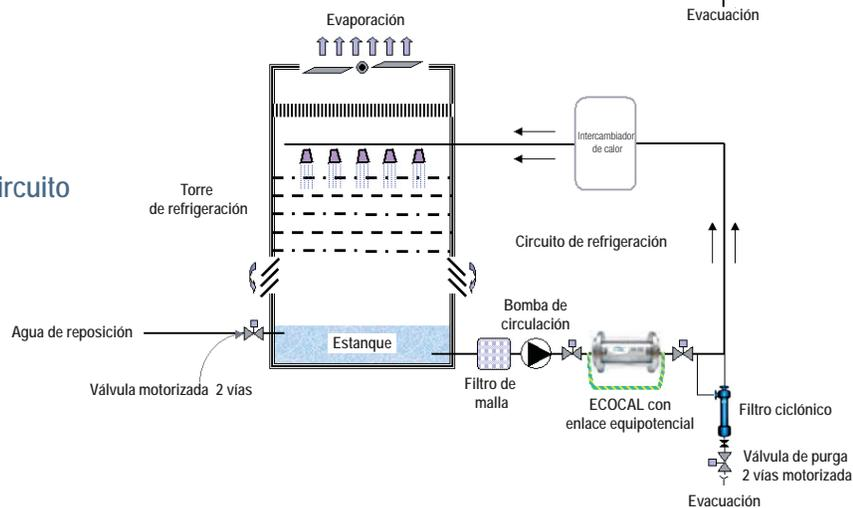
Montaje en bucle sobre circuito recirculación del estanque
