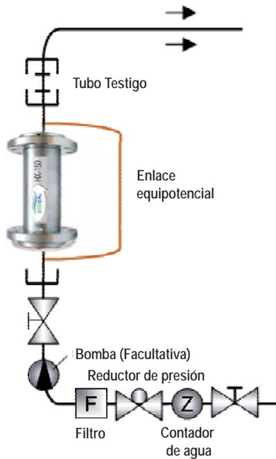
Instalación en una canalización PVC
